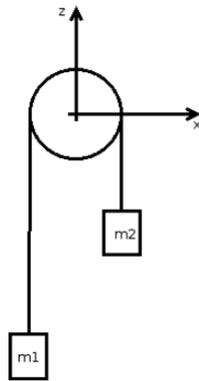
où  $I_{\Delta} = 5 \cdot 10^{-3} \text{ kg} \cdot \text{m}^2$ ,  $m_1 = 100 \text{ g}$ ,  $m_2 = 200 \text{ g}$  et  $R = 10 \text{ cm}$  (rayon de la poulie).
